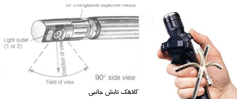
شکل ۶-۲، الف سیستم کنترل بوراسکوپ
