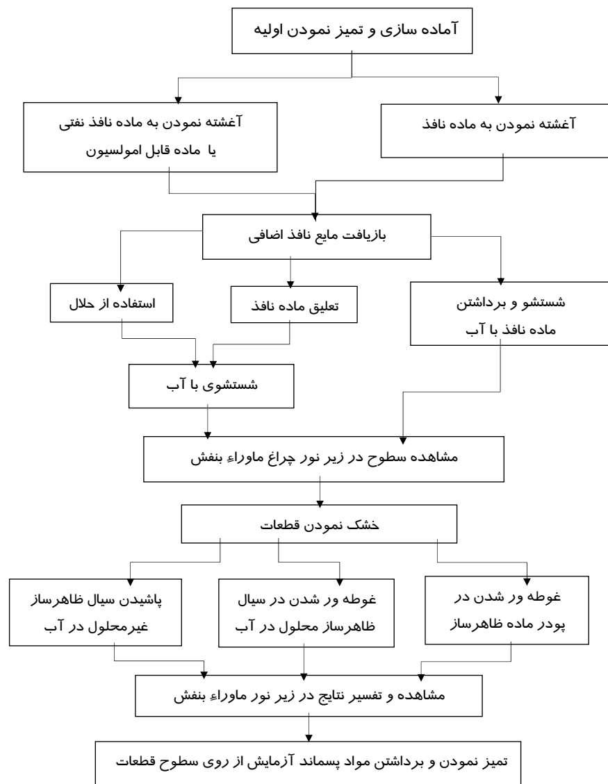
شکل ۵-۲ ، مراحل آزمایش با ماده نافذ فلورسنتی
